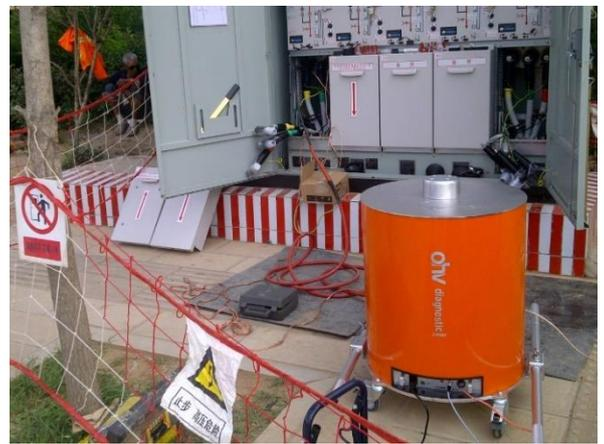
Das Testsystem wird in robusten Transport- und Lagerbehältern geliefert, die einfach per Lkw, Zug oder sogar Flugzeug zum Kabelteststandort transportiert werden können. Alle erforderlichen Niederspannungs- und Hochspannungskabel, Steckverbinder, Kalibrator und Grundlastkondensator zum Testen von kurzen Kabelstrecken sind im Satz enthalten.
